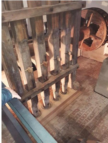
Über ein imposantes Räderwerk wurde zudem auch eine Knochenmühle, oder besser ein Pochwerk zum Pulverisieren von Knochen angetrieben.
