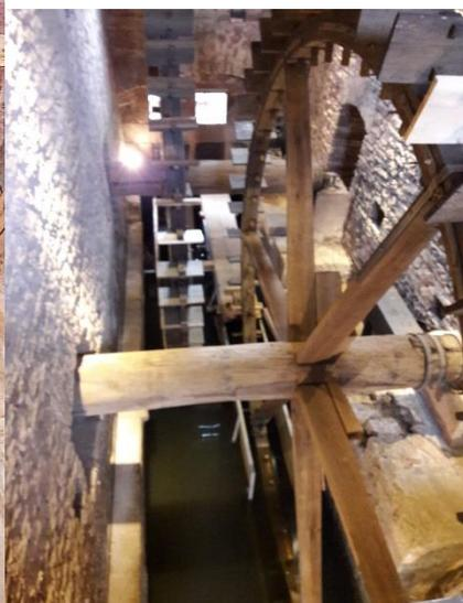
wobei Versailles als Vorbild diente. Das Wasser wird aus dem Grundwasser über Brunnen entnommen und durch Kolbenpumpen in einen Hochbehälter gepumpt. Als Antrieb für die Maschinerie dienen Wasserräder, angetrieben durch den Leimbach.
